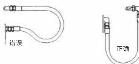
当弯曲半径太小时，宜采用直角接头以免胶管出现急弯。
